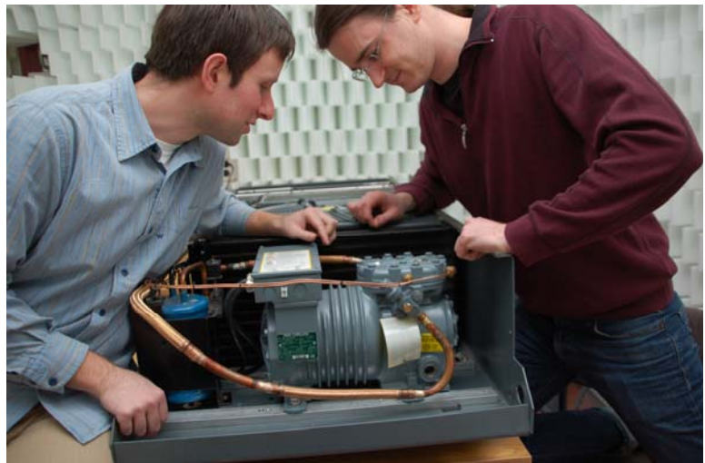
EU Projekt InMAR: Aktiver Tilger dämpft Lärm eines Kompressors. (Bild: Fraunhofer LBF)
